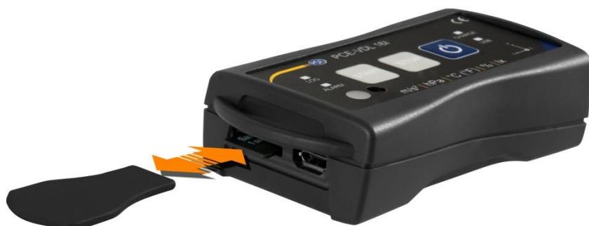
Um die microSD-Karte aus dem Datenlogger zu entnehmen, führen Sie das Schiebelement in die Speicherkartenaufnahme ein. Die Speicherplatte löst sich aus ihrer Halterung und schiebt sich so aus dem Gehäuse, dass sie anschließend herausgenommen werden kann.
